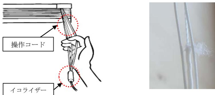
開閉を繰り返すうちに、操作コードに絡み（ねじれ）が生じる場合があります。その際は、髪をとかすように操作コードの絡みを整えてください。コードの絡みが多い状態で使用し続けると操作が重くなったり、コードが摩耗しコードが切れてしまう可能性があります。お客様が安心してご使用いただくために定期的なコードの絡みを整えるメンテナンスを実施するよう必ずご説明ください。
