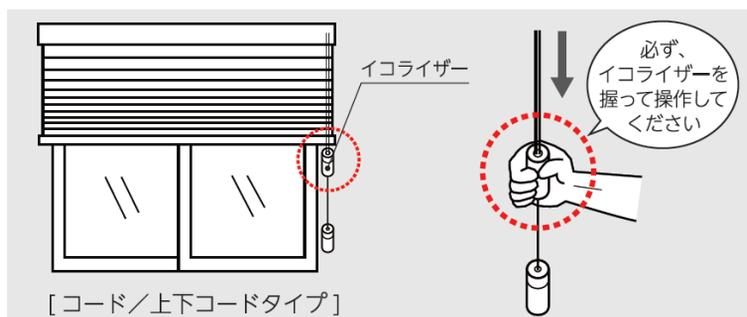
コードタイプ/上下コードタイプのイコライザーは、一定の荷重が加わるとイコライザーが外れる安全対策品です。その為、操作時に少し乱暴に扱うとイコライザーが外れる場合があります。操作をするときは、必ずイコライザーを握って操作をするようお願いいたします。
