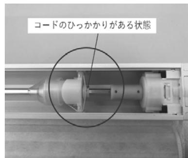
④内部でひっかかりができてしまうと、下の画像のように、操作した際にレールにひっかかった長さ分の傾きが生じてしまいます。
