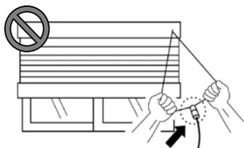
首吊り事故を防ぐ為に、イコライザーは、以下のような負荷を掛けると操作コードが外れる仕組みになっておりますので、故意に荷重などを掛けしないでください。
