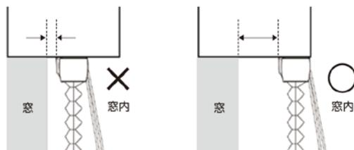
2.ブラケットのビス位置をマーキングしドリルで下穴を開ける。ブラケットを専用ビスで固定する。
