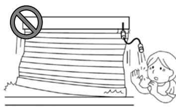
スクリーンを降ろす際には、スクリーンが降りきるまで操作コードを手から離さないでください。操作中にコードを離した場合、勢いよくスクリーンが下がり、ブラインドの破損や不具合、窓枠や床面を傷つける可能性があります。
