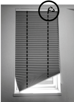
内部でコードが絡まっている状態
