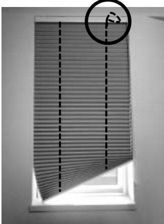
内部でコードが絡まっている状態
